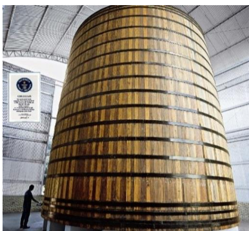
Figura 2 - Tonel de madeira usado para envelhecimento da cachaça. Fonte: www.ypioca.com.br
